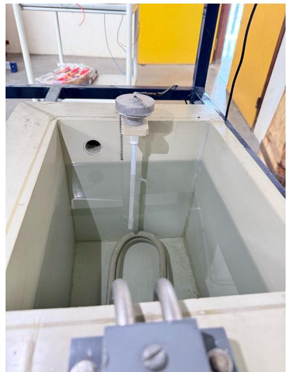
Sur la photo de gauche on peut voir une vue de face du thermoplongeur, qui permet de chauffer l'eau et sur la photo de droite on peut voir la sonde de température PT100, qui est relié au transmetteur et permet de mesurer la température de l'eau.
