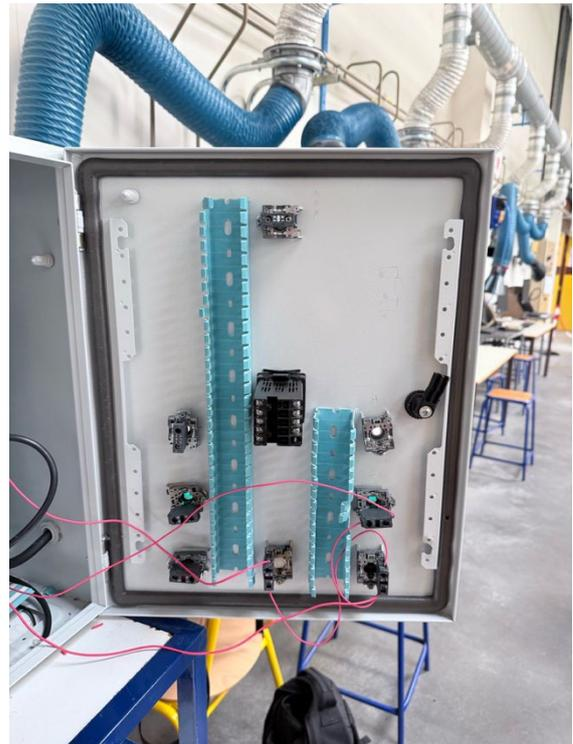
Voici le câblage du coffret électrique avec sur la photo de droite les 3 boutons, arrêt, marche et arrêt d'urgence. Sur la photo de gauche l'automate, le transformateur, le relais statique, le transmetteur ainsi que toutes les protections (disjoncteur et contacteur).
